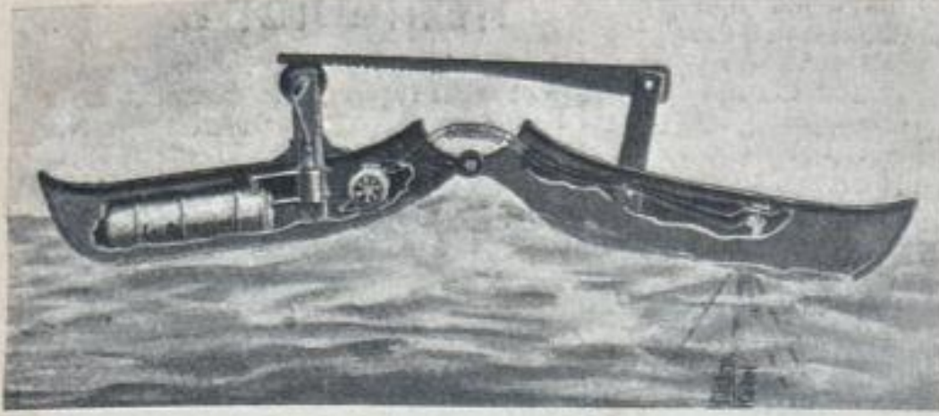
Приспособление для использования энергии морских волн.
